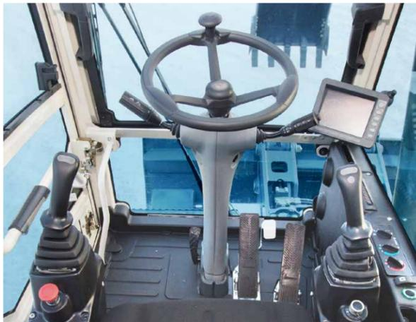
**Рулевая колонка** имеет узкий профиль и не загромождает обзор. Колонка имеет регулировки по вылету и углу наклона. Органы управления коробкой передач удобно сгруппированы на рулевой колонке.
