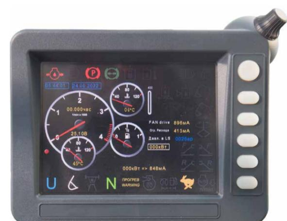
**ЖК дисплей** диагональю 7 дюймов, отображает все ключевые показатели работы экскаватора. На дисплей также выводится изображение камеры заднего вида.
