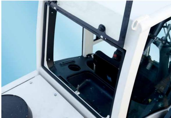
**Открывающееся заднее окно** обеспечивает удобное проветривание, может служить аварийным выходом при чрезвычайных ситуациях, полезно при проведении ТО и ремонта.
