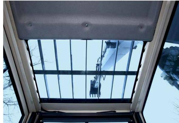
**Оконный проем в крыше кабины** с защитной решеткой обеспечивает визуальный контроль рабочего оборудования.
